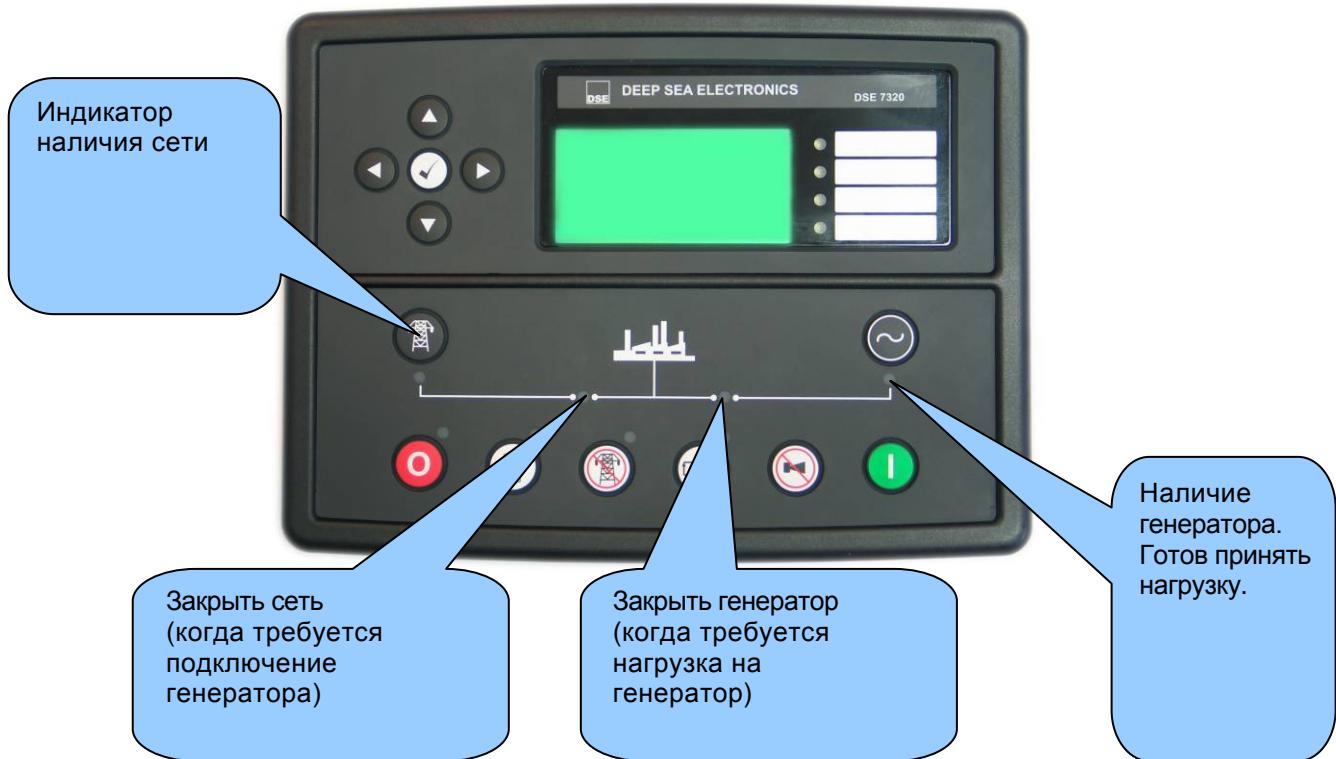
**▲ ПРИМЕЧАНИЕ:** - Индикатор “Генератор под нагрузкой” может работать в двух режимах в зависимости от настройки входов контроллера:
